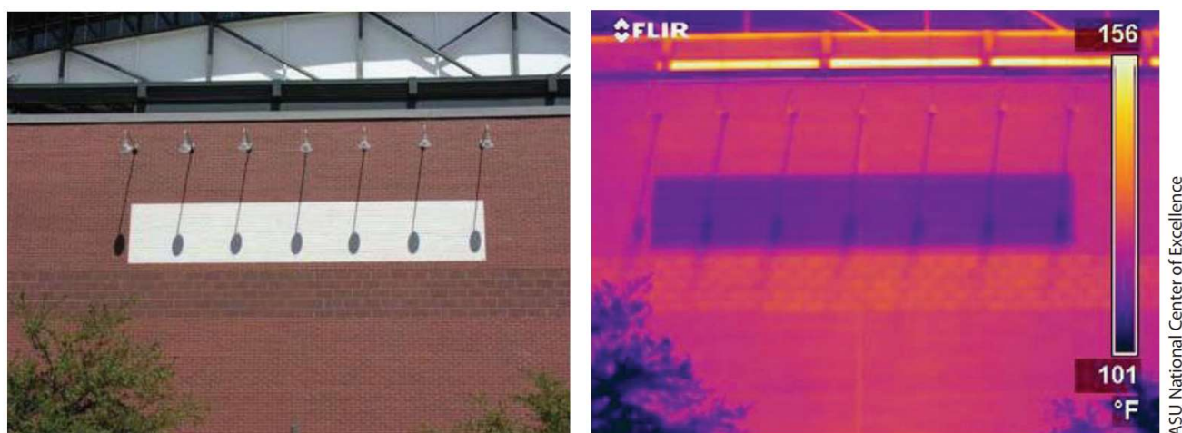
Figur 3.13: Temperaturforskel baseret på albedo. Temperaturforskellen mellem den hvide stribe og murstensvæggen er 3-5 grader C (EPA, 2012).
