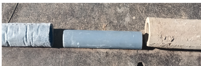
Materialer til alternativ reparation af lerrør
