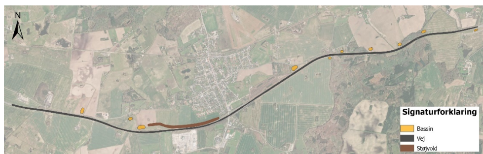
Figur 1: Oversigt over motorvejsstrækningen og placeringen af de 10 regnvandsbassiner.
