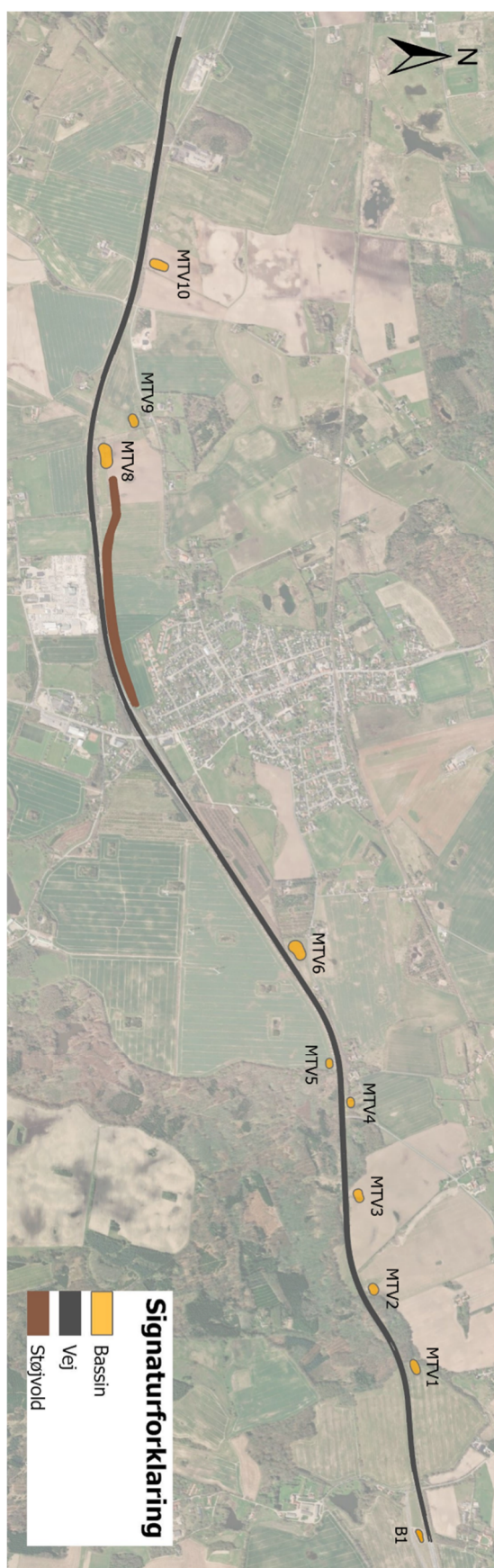
Figur 27: Oversigt over vejstrækning med bassiner og støjvold
