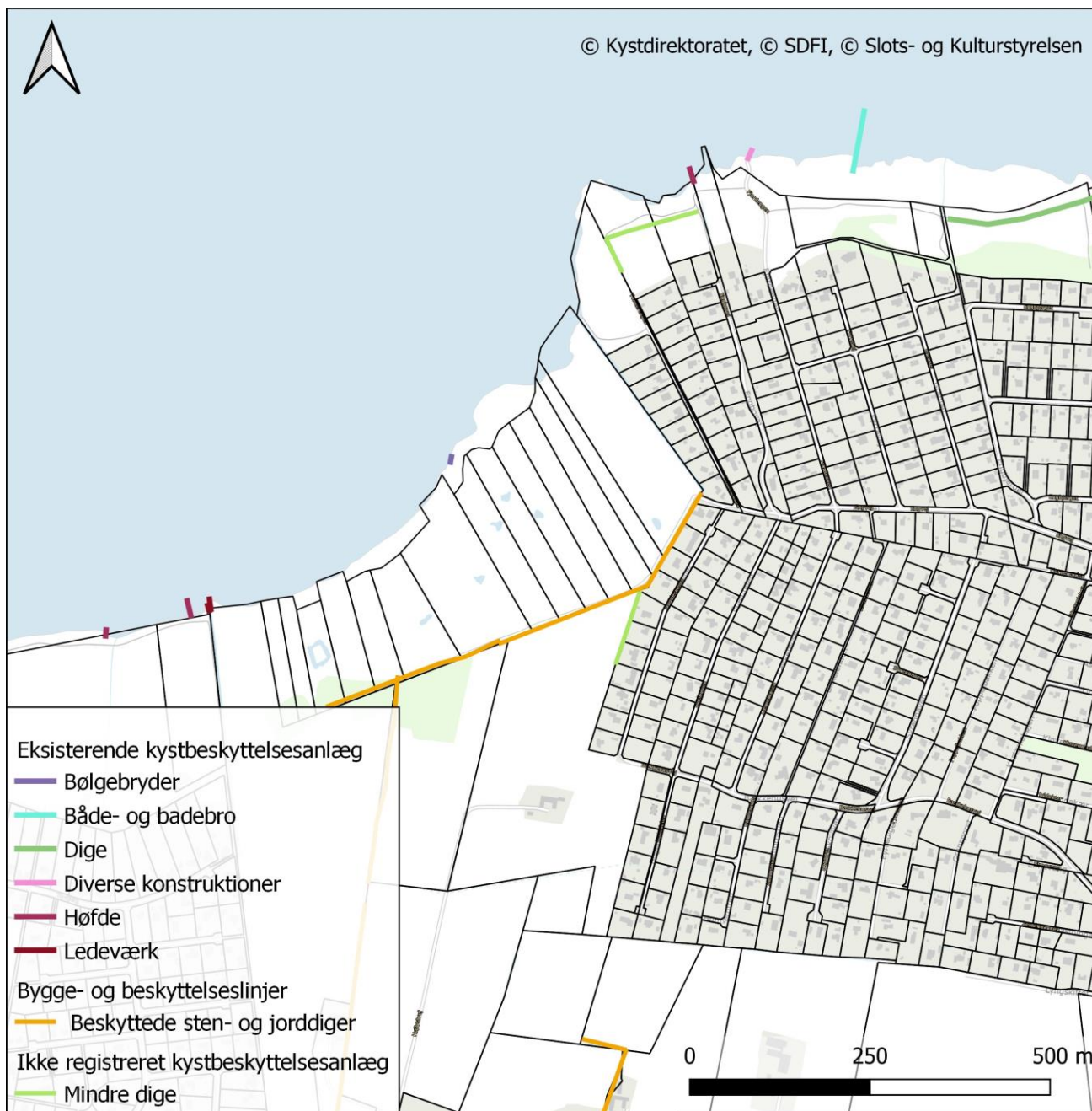
Figur 2.3: Eksisterende kystbeskyttelses anlæg registreret i Kystdirektoratets Kystatlas, beskyttede sten- og jorddige samt et ikke registreret mindre dige/jordvold.
