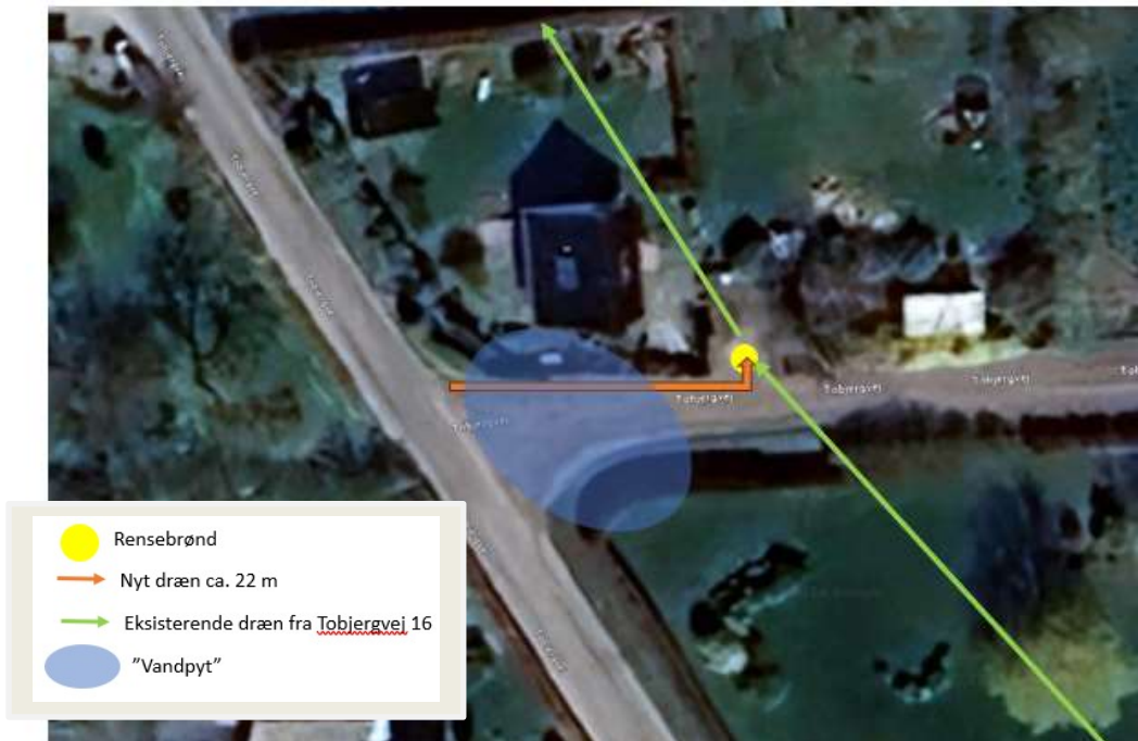
Figur 2. Oversigtskort fra ansøgningsmaterialet. Tobjergvej 20, er en hjørnegrund, der grænser op til Tobjergvej mod vest og syd. Placering af en ny drænledning (orange signatur) på Tobjergvej 20 er skitseret med en placering langs det sydlige matrikelskel, parallelt med grusvejen Tobjergvej. Eksisterende drænledning er illustreret med grøn ret linje, nord-syd gående. Eksisterende drænledning ses at krydse Tobjergvej 20.
