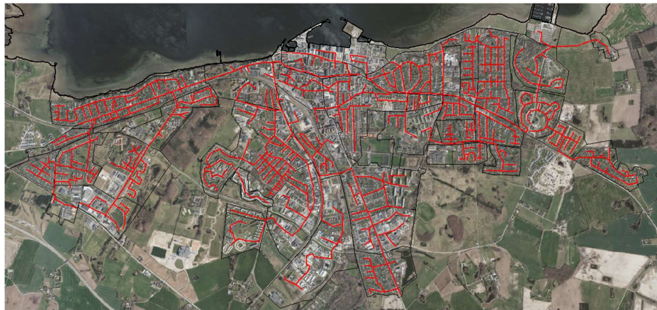
Figur 2 Oversigt over ledningsnet i Holbæk by
