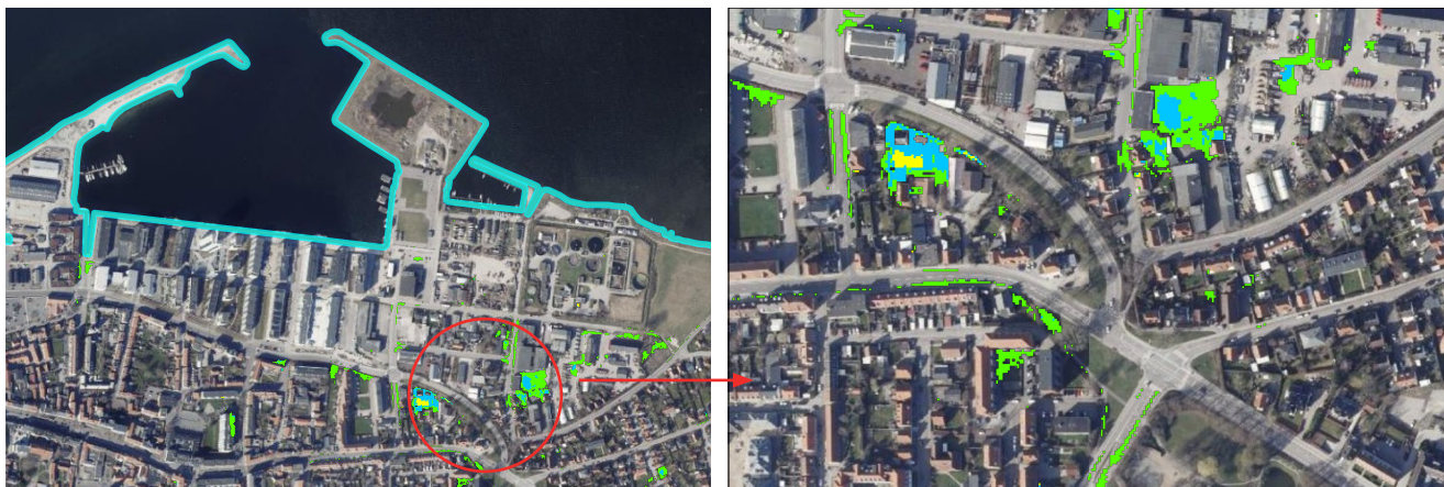
Oversvømmelse ved en 20 års ved Havnevej i Holbæk
